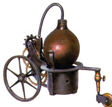
Рис. 3.34. Паровая турбина на колёсах
