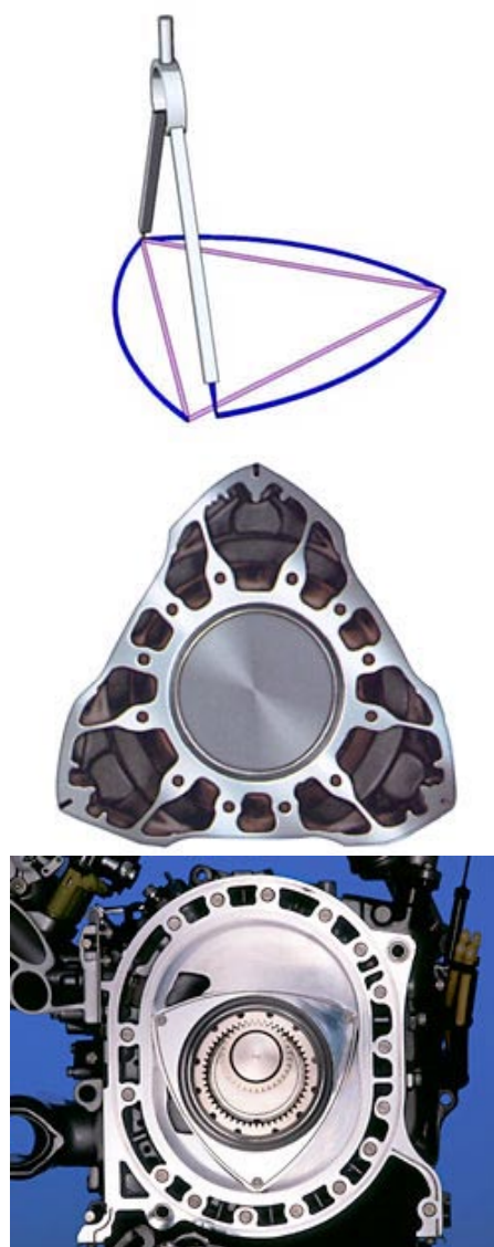
Рис. 3.152. Форма ротора и статора роторного двигателя
