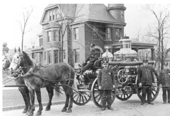
Рис. 3.39. Пожарный вариант парового насоса
